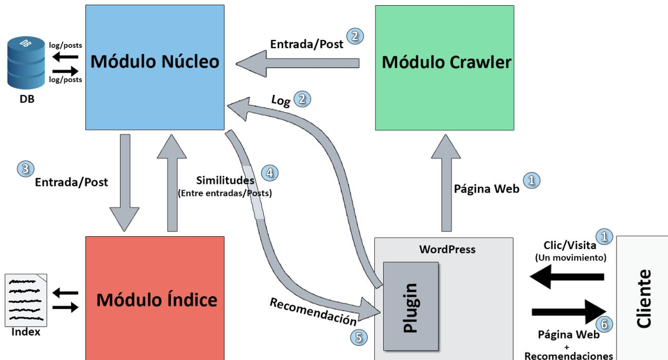
**Figura 3.1:** Arquitectura del proyecto. Los marcadores numéricos sirven para dar una idea de la secuencia de los procesos del sistema y de las llamadas que pueden realizarse a la vez (indicadas usando el mismo número).
